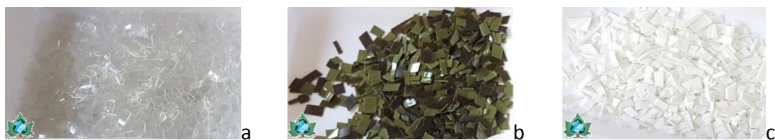
Fig. 46. Probe după tăierea cu foarfeca metalică: a. PET incolor; b. PET colorat; c. HDPE
