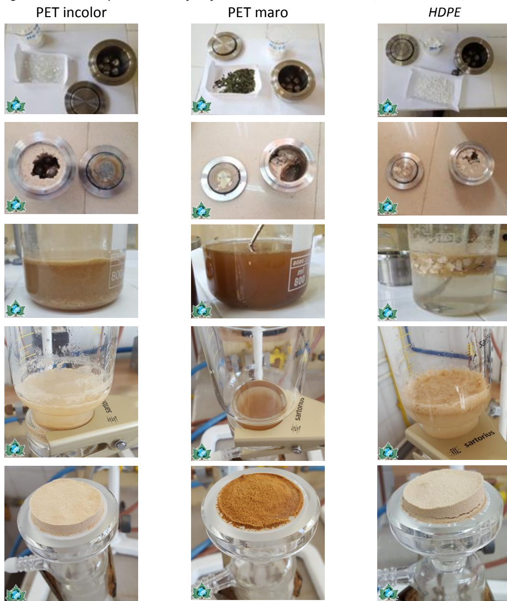
Fig. 47. Procesul de obținere a microparticulelor de plastic
