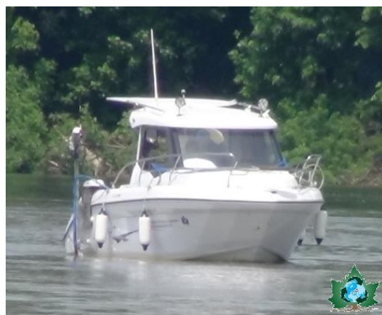
Fig.39 Efectuarea măsurătorilor multibeam și echipamentul utilizat montat pe ambarcațiune: GeoSwath Plus Compact
