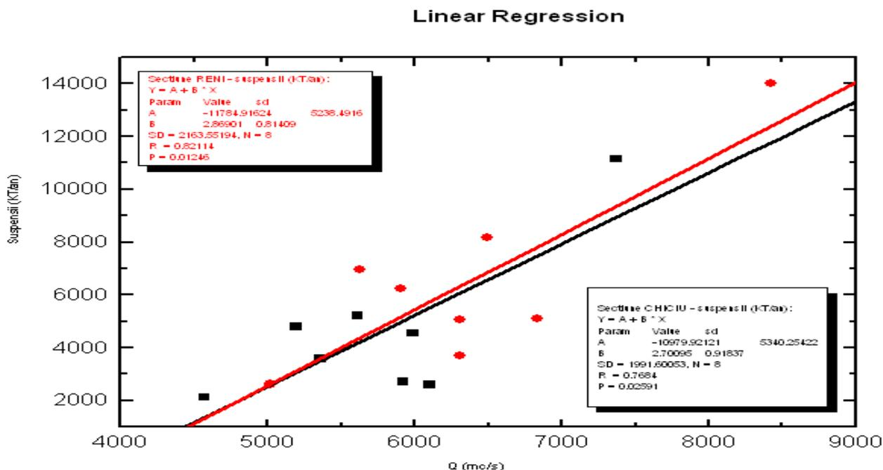
Figure 3.3.2 -  $K_T \text{ suspensii} = f(Q \text{ m}^3/\text{s})$  correlation at Chiciu - Silistra și Reni monitoring stations (1998 - 2009 period)
