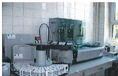
Analizor automat în flux continuu segmentat model SAN++
