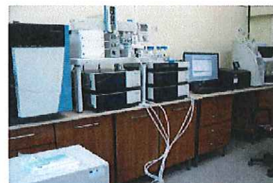
Sistem modular UHPLC ONLINE SPE – EQvan MAX cuplat cu spectrometru de masă cu triplu cuadru pol LC-MS/MS TSQ Quantiva
