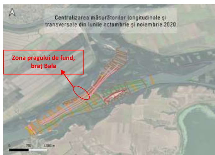
Figura 20. Situația centralizată a măsurătorilor single-beam longitudinale și transversale realizate în perioada octombrie – noiembrie 2020
