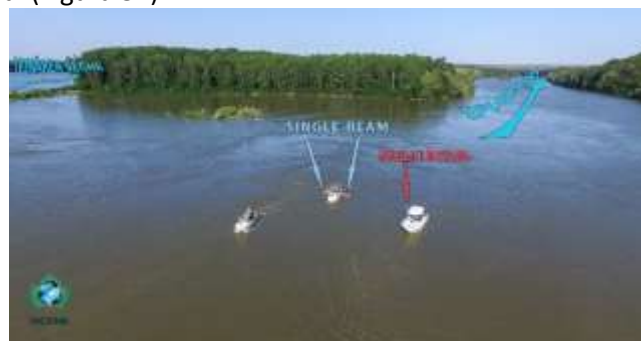
Figura 32. a) Cuneț realizată la intrarea pe brațul Epurașu, b) măsurători single-beam și multibeam
