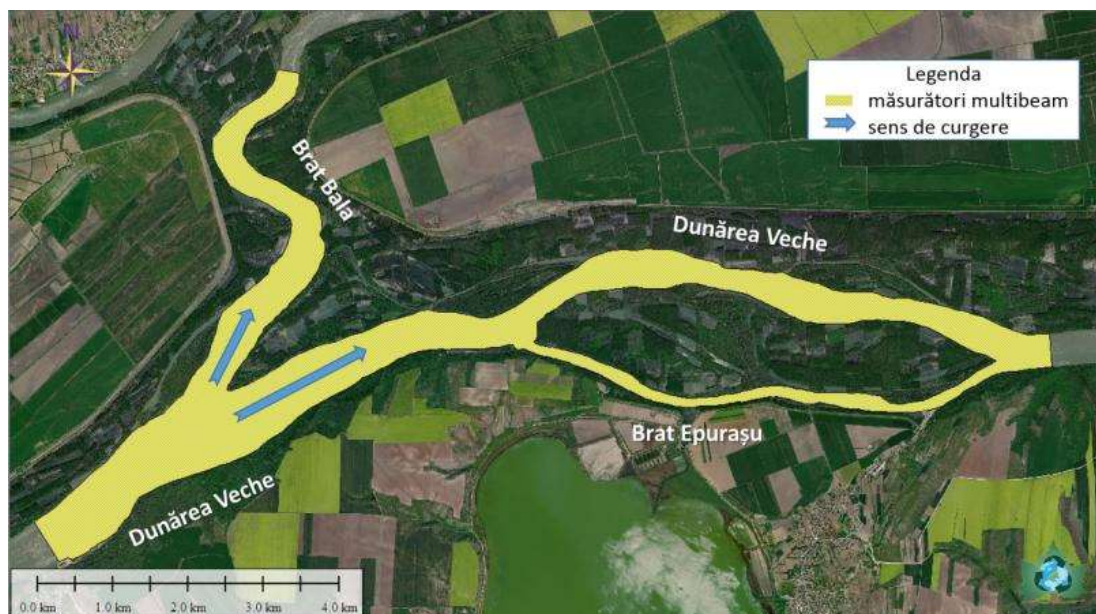
Figura 40. Campanie măsurători multibeam de înaltă rezoluție – 2020
