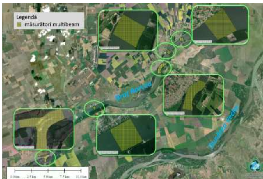
Figura 68. Măsurători multibeam Brațul Borcea
