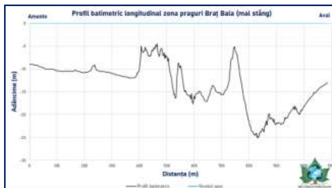
Figura 75. Profil batimetric longitudinal Braș Bala – mal stâng
