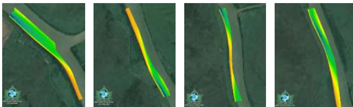
Figura 92. Reprezentări 2D ale batimetriei multibeam de înaltă rezoluție
