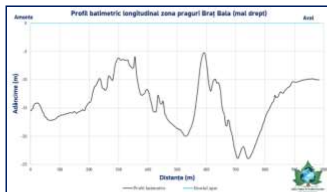
Figura 77. Profil batimetric longitudinal Braș Bala – mal drept
