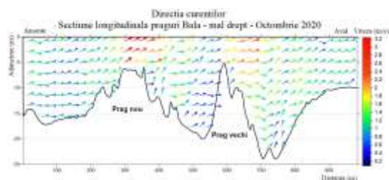
Figura 23. Direcția curenților pe o secțiune longitudinală braț Bala (mal drept)
