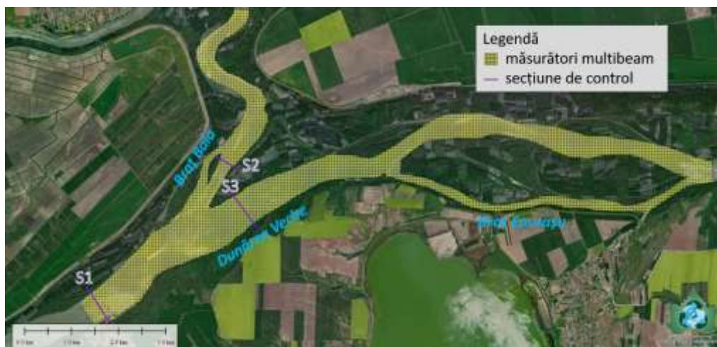
Figura 67. Arie acoperită de măsurători multibeam în zona secțiunilor de control Dunărea Veche – Braț Bala
