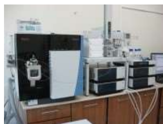
Sistem UHPLC ONLINE SPE - EQuan MAX Plus™, TSQ Quantiva - Determinare compuși farmaceutici
