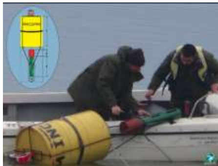
Stație de monitorizare DKMR-01T in situ
