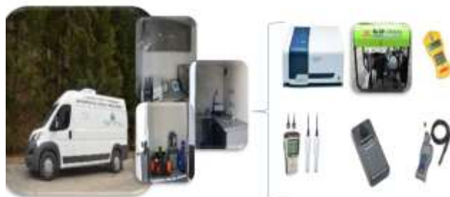
Autolaborator pentru monitorizarea calității apei și solului.
