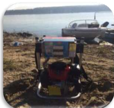
Aparat de pescuit electric de putere mic HANS GRASSL ELT 60 II HI cu accesorii
