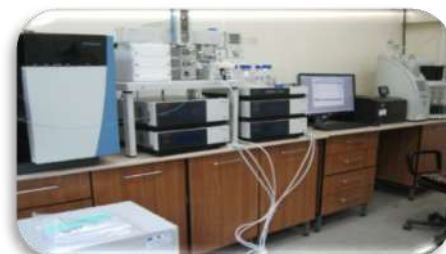
Sistem modular UHPLC ONLINE SPE - EQuan MAX cuplat cu spectrometru de masă cu triplu cuadrupol LC-MS/MS TSQ Quantiva
