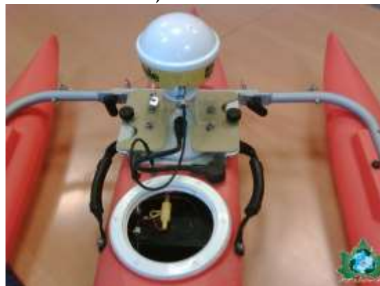
Efectuarea măsurătorilor single-beam ADCP și echipamentul utilizat: RiverRay
