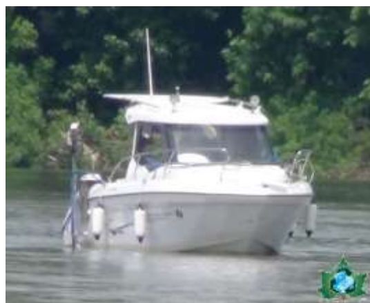
Efectuarea măsurătorilor multibeam și echipamentul utilizat montat pe ambarcațiune: GeoSwath Plus Compact
