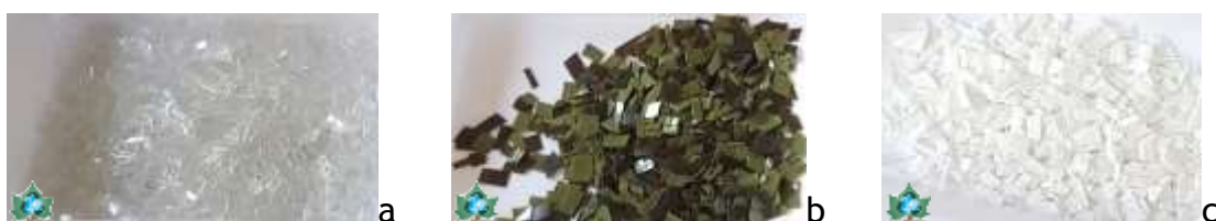
Probe după tăierea cu foarfeca metalică: a. PET incolor; b. PET colorat; c. HDPE PET incolor PET maro HDPE
