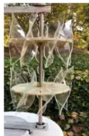
Turbină cu 16 pale pe 2 etaje
