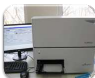
CLARIOstar 430-101 (cititor de microplăci de înaltă performanță cu detecție multiplă) - Analize biologice și biochimice (analize enzimatic; teste ELISA, determinarea colorimetrică a endotoxinelor etc).
