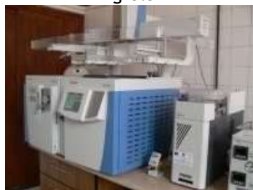
Gaz cromatograf Trace 1310 cuplat cu spectrometru de masă triplu cuadрупol - TSQ 8000Evo - Determinare hidrocarburi aromatice policiclice (PAH)
