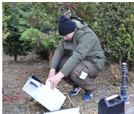
Prelevator activ tip Desaga, măsurare TSP
