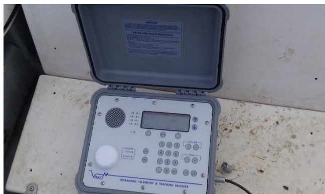
Sonar pentru monitorizarea activă a sturionilor
