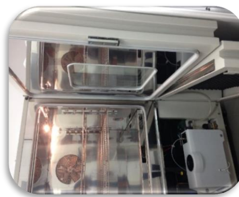
Cameră climatică de testare și simulare condiții climatice succesive model Discovery My 600
