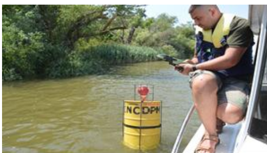
Georeferențierea stațiilor de monitorizare tip DKMR-01T
