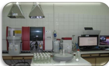
Spectrometru de absorbție atomică de înaltă rezoluție, cu sursă continuă - HRC SAAS ContrAA 700
