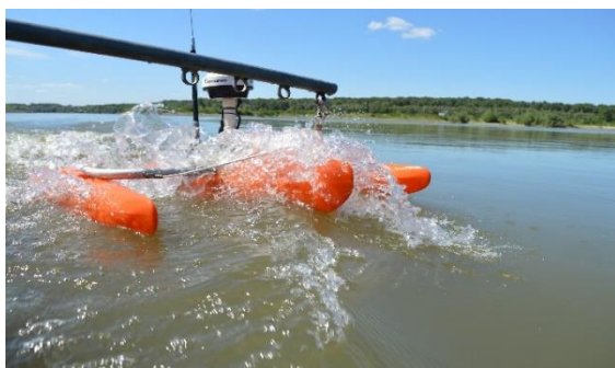
Echipament ADCP pentru măsurarea debitelor și vitezelor
