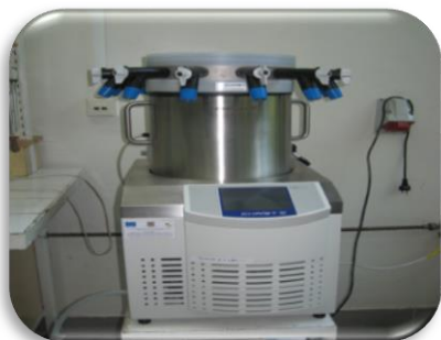
Sistem de crioscure ALPHA 2-4 LSCplus
