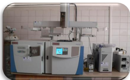
Sistemul GC-MS/MS Trace 1310 cuplat cu spectrometru de masă TSQ 8000 Evo
