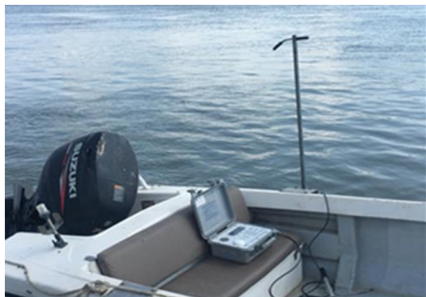
Monitorizare mobilă receptor VR100
