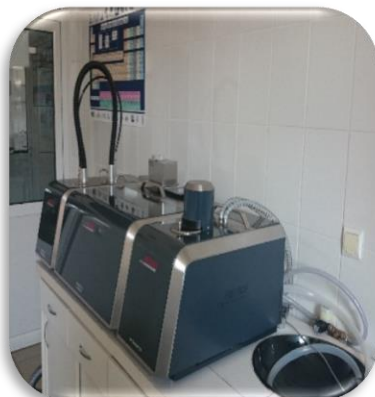
Analizor de particule în probe lichide și pulberi Model Analysette 22 NanoTech
