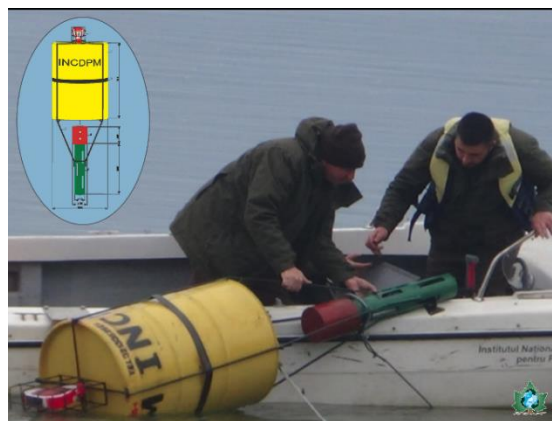
Stație de monitorizare DKMR-01T in situ
