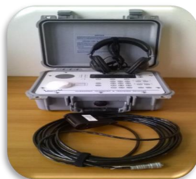
Analizor de zgomot și vibrații tip sonometru 2270, Bruel& Kjaer
