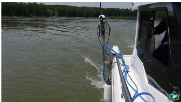
Sistem multibatimetric Kongsberg GeoSwat Plus Compact montat pe ambarcatiunea Ranieri CLF 22
