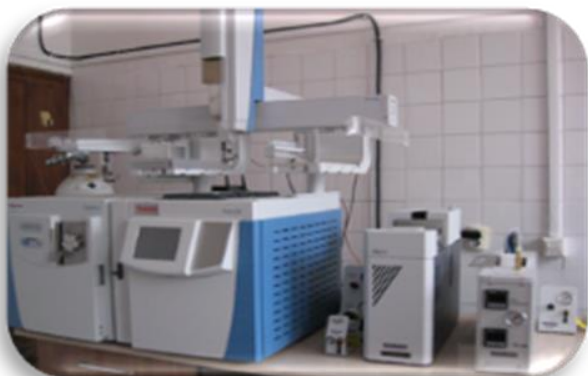
Sistem GC-MS/MS Trace 1310 cuplat cu spectrometru de masa TSQ 8000 Evo, Thermo Scientific
