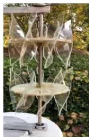
Turbină cu 16 pale pe 2 etaje
