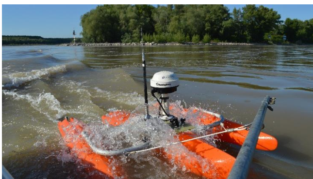
RiverRay ADCP pentru măsurători de debite-viteză
