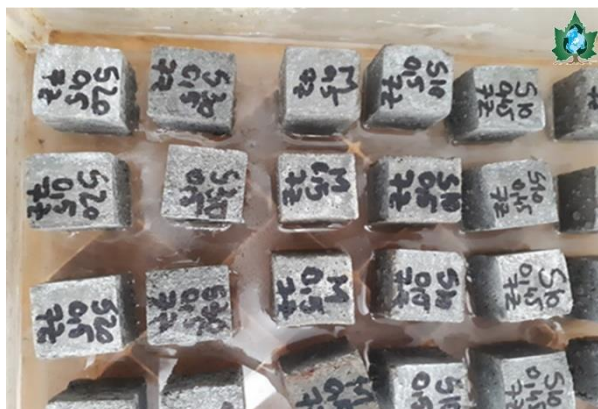
Preparare mortar hidratat
