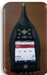
Analizor de zgomot și vibrații tip sonometru 2270, Bruel& Kjaer
