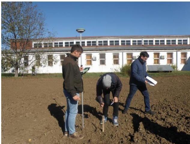
Ajustarea poziției jaloanelor cu ajutorul echipamentului GPS
