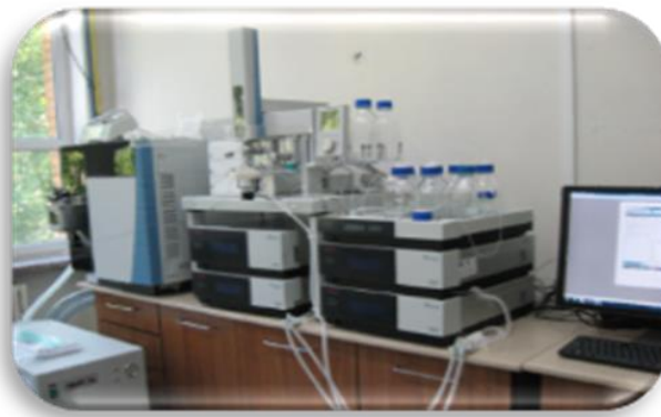
UHPLC ONLINE SPE - EQuan MAX cuplat cu spectrometru de masa cu triplu cuadrupol LC-MS/MS TSQ Quantiva
