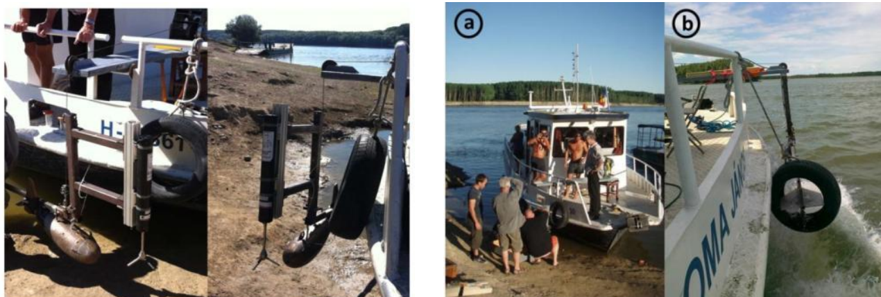
Fig. 3.1.D.1.3.2 - Echipamentul de măsurat ADV
