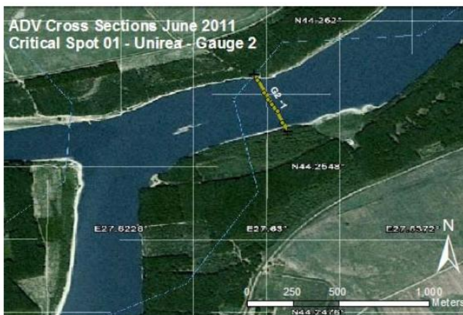
Fig. 3.1.D.1.3.4 - Poziția secțiunilor transversale ADV - zona Unirea
