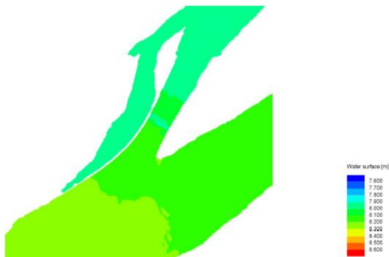
Figura 8 - Nivelul absolut al apei Q5530 \text{ m}^3/\text{s}
