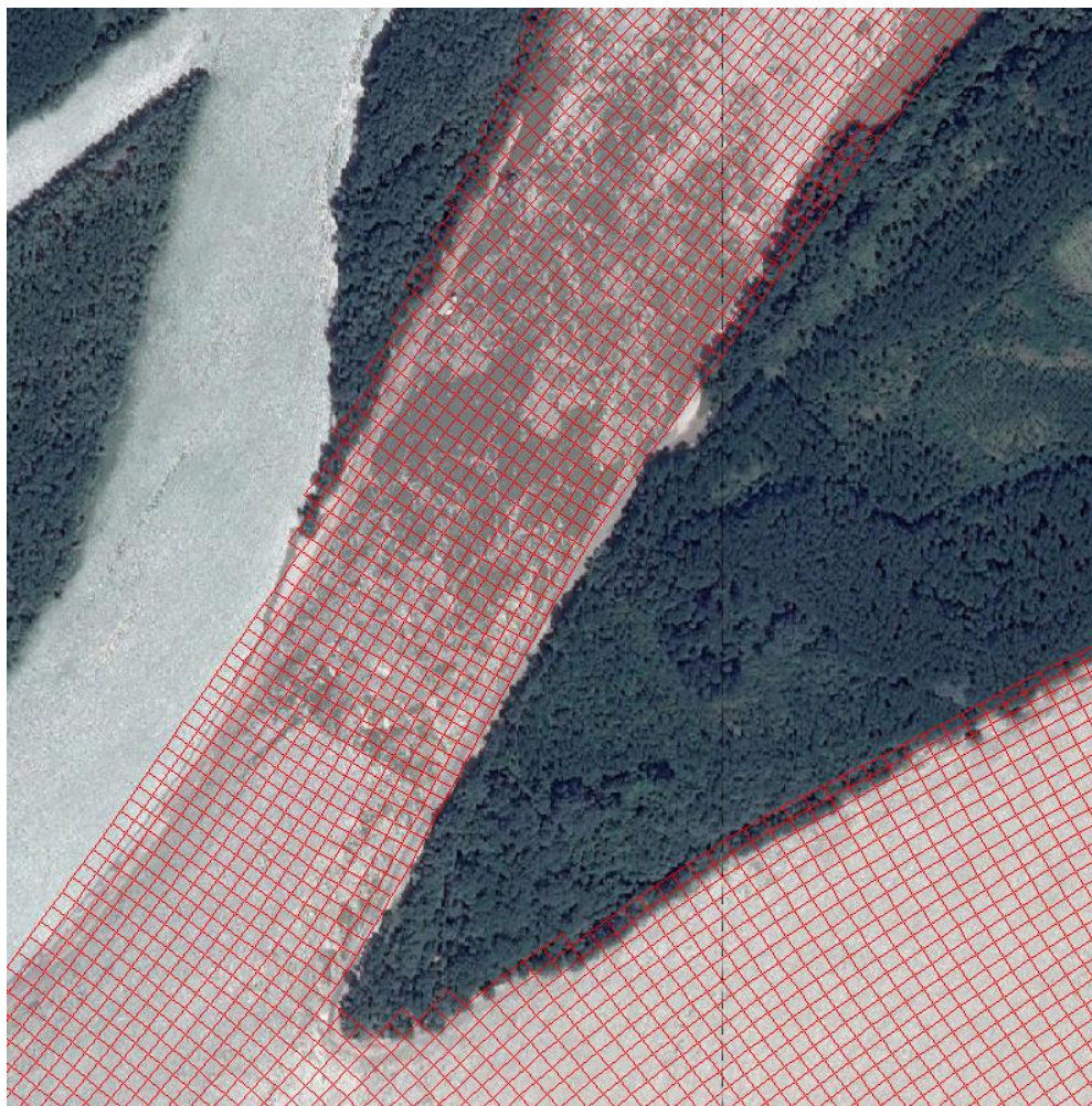
Figura 23 - Detaliu al gridului de calcul zona bifurcație Bala mai 2015
