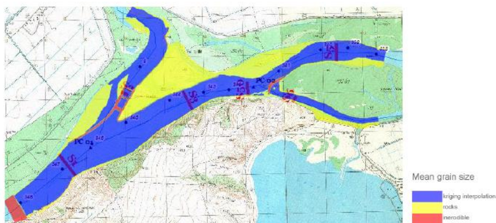
Figura 17 - Materialul din patul albiei - situație inițială - clasificare
