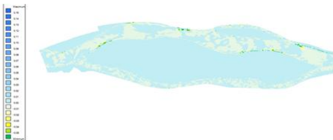
Figura 2.2.14 - Rezultate ale simulării numerice cu modelul Delft3D, tendințe de eroziuni (arii colorate cu verde) la maluri pe Dunărea Veche, în aval de digul de la punctul critic 02, la debit de circa 2640 m 3 /s
