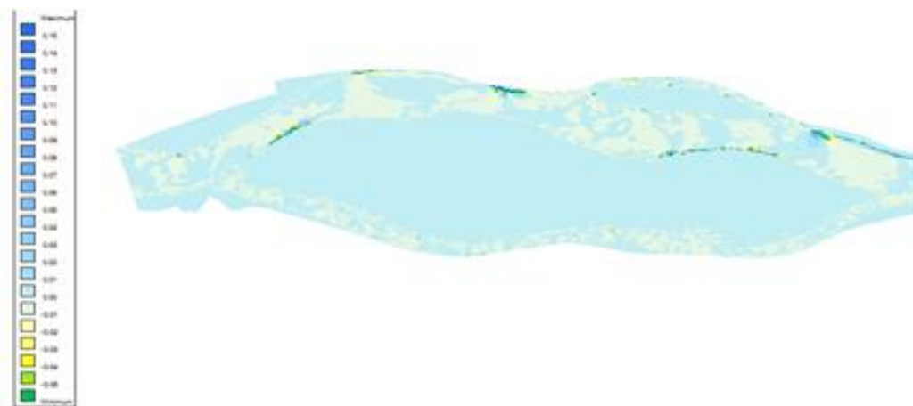
Figura 2.2.15 - Rezultate ale simulării numerice cu modelul Delft3D, tendințe de eroziuni la maluri (arii colorate cu verde) și depuneri în arii vecine (colorate cu albastru) pe Dunărea Veche, în aval de digul de la punctul critic 02, la debit de circa 2640 m 3 /s
