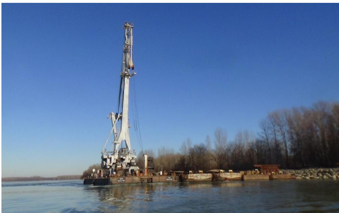
Fig.2.1.1. -Bala PC01 - Macara plutitoare 16 tf cu greifer
